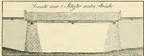
Abb. 138. Klützelholzbrücke der Linz-Budweiser Pferdebahn.
